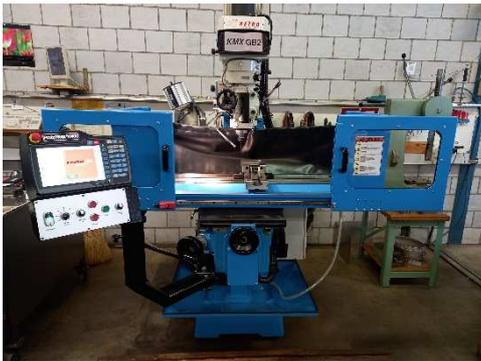
Universal Fräs- und Bohrmaschine RETRO TRAK GB2
