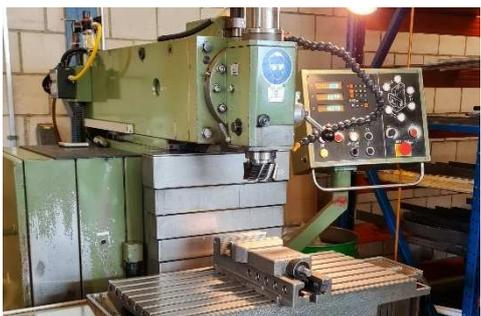
Fräsmaschine horizontal und vertikal TOS FNGJ-32
